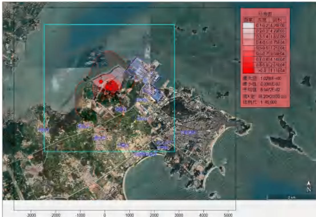
图 5.2.19 叠加后排放颗粒物年均值质量浓度等值线分布图单位: \mu\text{g}/\text{m}^3
