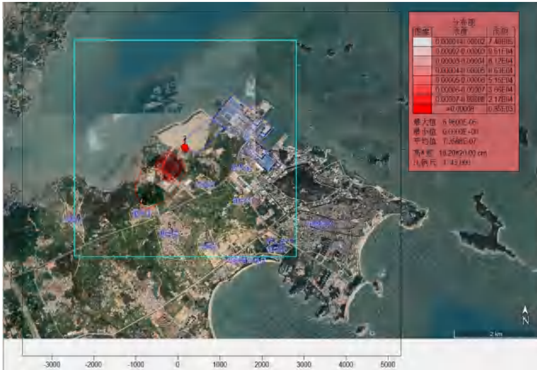
图 5.2.11 正常排放非甲烷总烃小时均值质量浓度等值线分布图单位: \mu\text{g}/\text{m}^3
