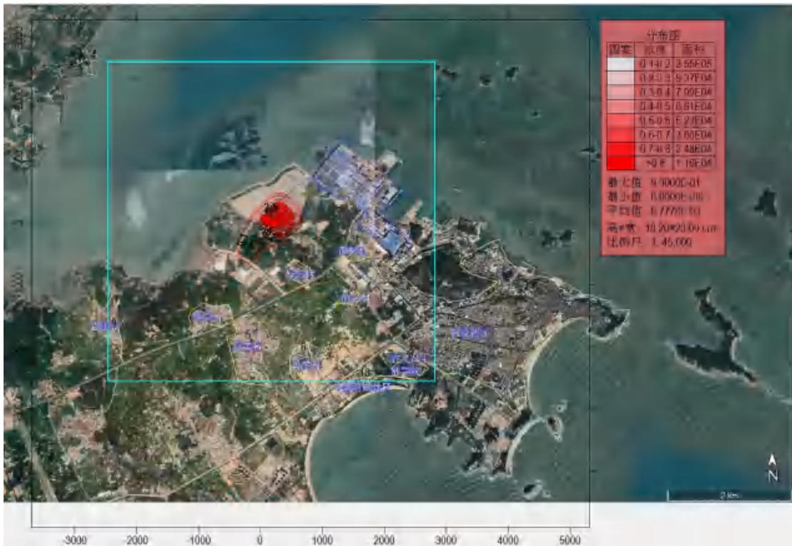
图 5.2.16 正常排放颗粒物年均值质量浓度等值线分布图单位: \mu\text{g}/\text{m}^3
